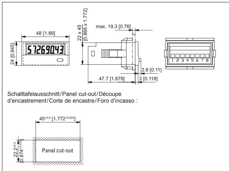
Schalttafelausschnitt/Panel cut-out/Découpe d'encastrement/Corte de encastre/Foro d'incasso :
