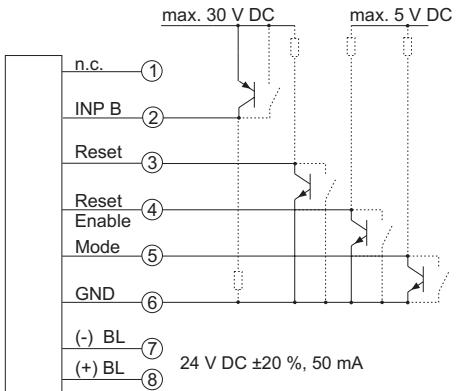
BL = Hinterleuchtung/backlight/rétroéclairage/retroiluminación/retroilluminazione
