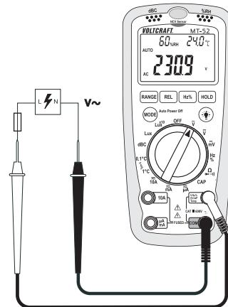
La plage de mesure mV-CA peut uniquement être sélectionnée à l'aide de la sélection manuelle de la plage de mesure (touche « PLAGE »).
