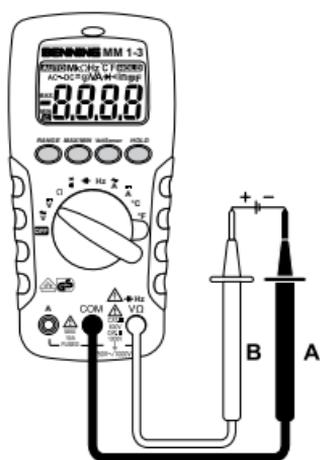
Bild 2: Gleichspannungsmessung
