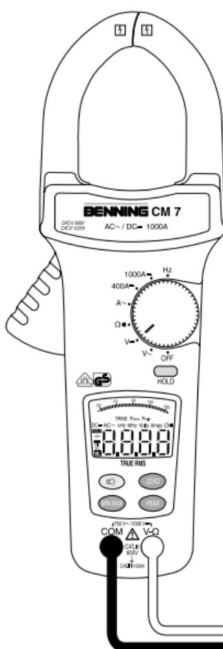
Bild 2: Gleichspannungsmessung
