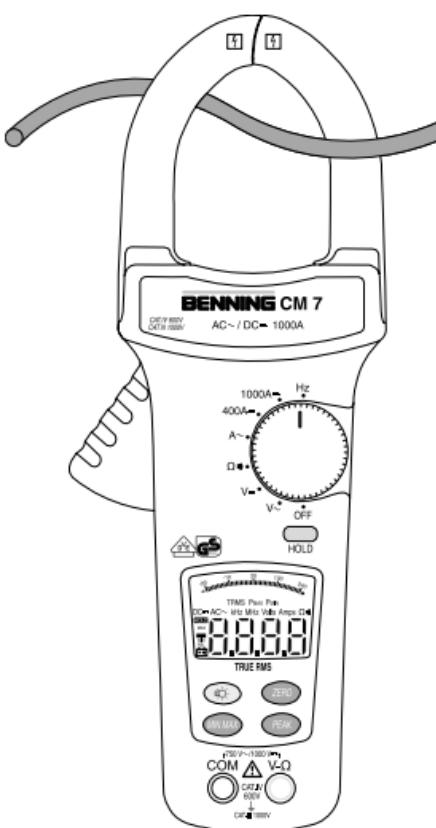
Bild 6: Frequenzmessung
