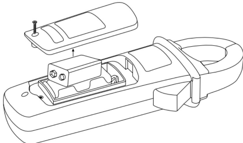
Bild 7: Batteriewechsel
