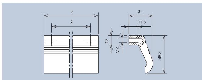
Einschließlich Zylinderschrauben-M6 x 12 und Scheiben.
