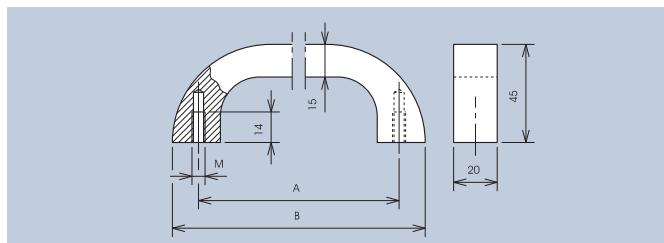
Einschließlich Zylinderschrauben-M6 x 12 bzw. M8 x 12 und Scheiben.
