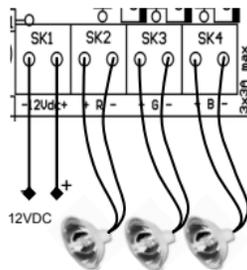
**Ampoule à incandescence ou halogène :**
