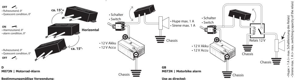
Alarmgeber zum Überwachen von Geräten oder Fahrzeugen, indem bei einer Veränderung des Neigungswinkels eine Alarmsirene oder Lampe eingeschaltet wird.
