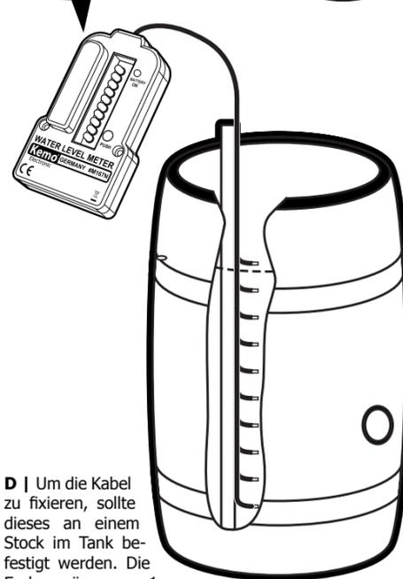
**D |** Um die Kabel zu fixieren, sollte dieses an einem Stock im Tank befestigt werden. Die Enden müssen ca. 1 - 3 cm blank abisoliert sein.
