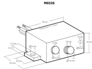
Verstärkermodul mit Buchsen für den Signaleingang und für die Stromversorgung.
