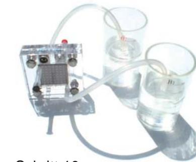
**Schritt 9:** Stellen Sie den Sauerstoff-Tank (E) neben die reversible Brennstoffzelle (C) auf derselben Seite wie das rote Schlauchanschlussstück und die rote Bananenbuchse. Befestigen Sie einen 16 cm umfassenden Gummischlauch (G) vom Gas-Behälter (F) im Innern des Sauerstoff-Tanks (D) mit der unteren rechten Düse auf derselben Seite wie das rote Schlauchanschlussstück und die rote Bananenbuchse.
