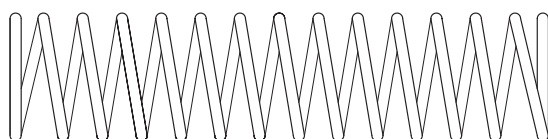
47A -- Shock Spring 1.5x80.5 mm -- 4
