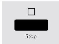
Drukt u de knop **Stop** lang in, totdat u een piepton hoort en de functie zichtbaar is in het display. In ontgrendelde stand zijn alle knoppen weer geactiveerd.
