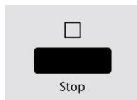
Drukt u de knop **Stop** drie seconden lang in, totdat u een piepton hoort en de functie zichtbaar is in het display. In vergrendelde toestand zijn alle knoppen gedeactiveerd.
