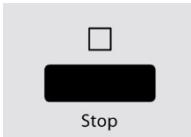
Pulse el botón **Stop** durante tres segundos, hasta que escuche una señal acústica y se apague un indicador de funcionamiento. Cuando el bloqueo está desactivado, el resto de los botones vuelven a activarse.
