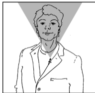
Fig. 4: Ángulo de toma del micrófono
