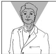
Abb. 4: Aufnahmewinkel des Mikrofons
