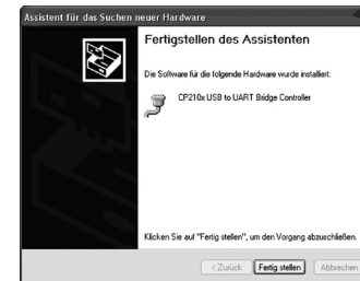
Abb. 12: Erfolgreiche Installation des zweiten Treibers
