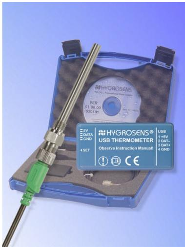
Das mehrkanalige Thermometer ist ein leistungsfähiges Mess- und Aufzeichnungssystem für bis zu 20 Temperaturkanäle mit einem Messbereich von  $-55$  bis  $125^{\circ}\text{C}$ . Als Temperaturfühler werden die DALLAS-Sensoren vom Typ DS 1820 eingesetzt, die über eine dreiadrige Leitung über bis zu 200m am PC-Adapter betrieben werden.
