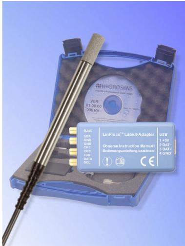
Die LinPicco™ Feuchtemodule liefern ein analoges Spannungssignal für die Feuchte. Zur Temperaturmessung dient ein passiver, auf dem Modul integrierter PT1000 Platinwiderstand. Die Anbindung an den PC erfolgt über ein USB-Modul mit A/D-Wandler und PT1000 Messbrücke.
