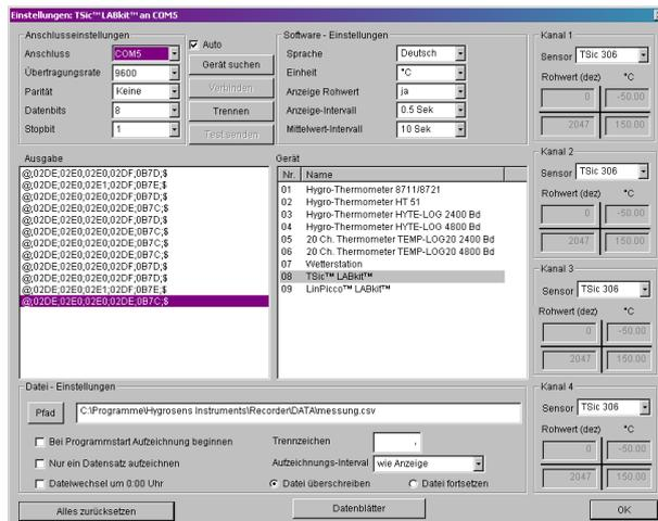
Links daneben befindet sich ein Terminalfenster („Ausgabe“), in dem der Datenverkehr mit dem Messgerät angezeigt wird. Dies dient als einfache Diagnosemöglichkeit der Kommunikation.
