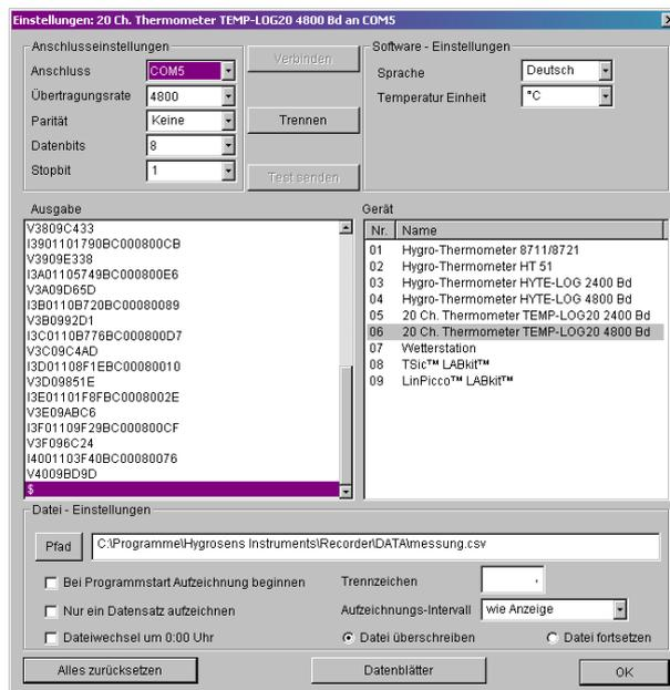
**Hinweis:** Sofern die Software auf das 4 Kanal TSic Temperaturmesssystem konfiguriert ist, müssen Sie unter Einstellungen die Tastenkombination ALT+E drücken um in die versteckten „Erweiterten Einstellungen“ zu gelangen, in denen Sie einen anderen Gerätetreiber anwählen können.
