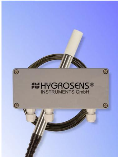
Dieses Produkt besitzt außer dem Feuchte- und Temperaturmessteil zusätzlich einen Drucksensor und vier Anschlüsse für weitere Sensoren wie Helligkeits-, Strahlungs-, Materialfeuchte- oder Restsauerstofffühler. Der gemessene Umgebungsdruck fließt als Eingangsgröße in den Hx-Rechner mit ein, so dass eine genauere Berechnung der Sekundärgrößen erfolgt.
