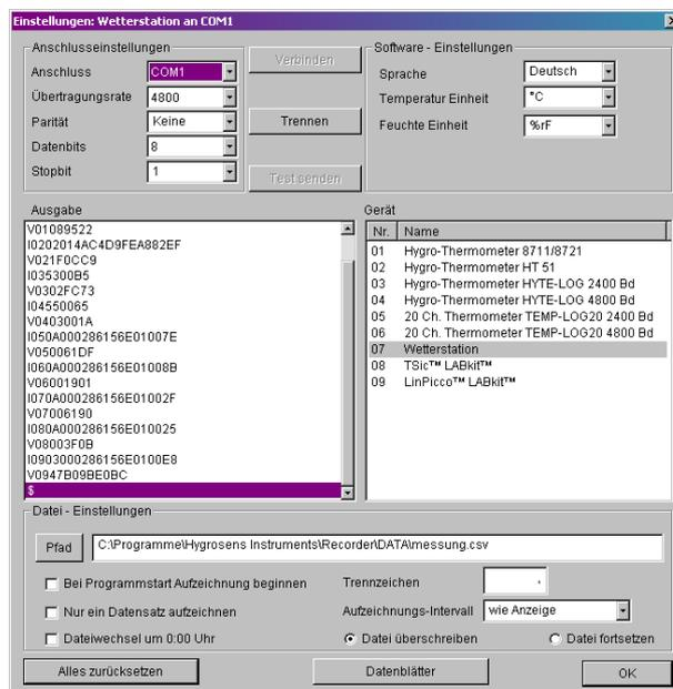
**Auswahlliste „Gerät“:** Diese Einstellung bestimmt das gesamte Programmverhalten und das äußere Erscheinungsbild der Fenster. Bevor Sie die Konfiguration fortsetzen, sollten Sie daher zuerst die richtige Einstellung überprüfen. Den Gerätetyp ändern Sie gegebenenfalls durch Klick mit der Maus auf die entsprechende Zeile der Auswahlliste.
