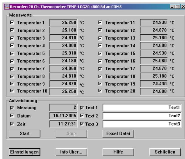
**Feld Messwerte, Schalter neben dem Messkanal:** Mit diesem Schalter bestimmen Sie, welche Kanäle in die Datei aufgezeichnet werden sollen.
