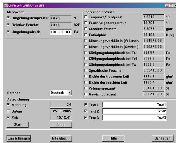
Messsystem empfangenen Datensätze fortlaufend hochgezählt und die Felder „Datum“ und „Uhrzeit“ werden automatisch vom System aktualisiert.
