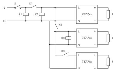
Abb. 3: Parallelschaltung von Netzgeräten
