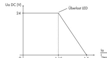
Abb. 4: Ausgangskennlinie
