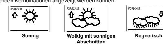
Bei plötzlichen oder größeren Schwankungen des Luftdrucks werden die Anzeigesymbole aktualisiert, um die Wetterveränderung anzeigen zu können. Ändern sich die Anzeigesymbole nicht, dann hat sich entweder der Luftdruck nicht verändert oder die Veränderung ist so langsam eingetreten, dass sie von der Wetterstation nicht registriert werden konnte. Wenn die Anzeigesymbole Sonne oder Reg
