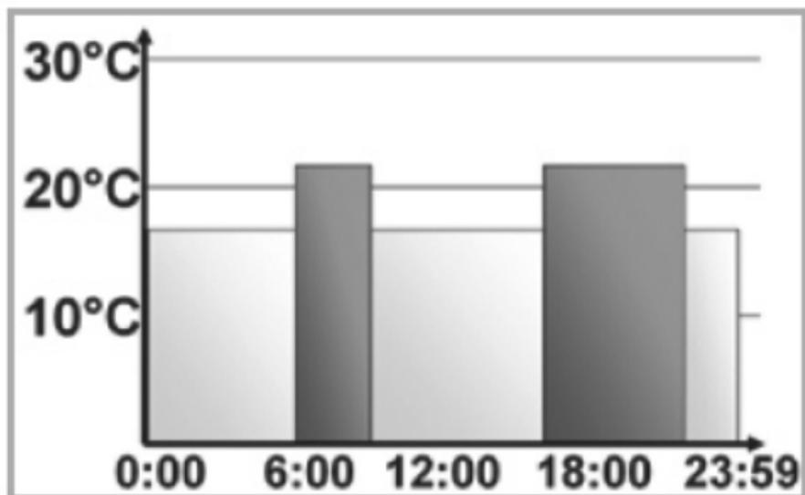
Im Display werden Balken für Heizphasen immer dann angezeigt, wenn die eingestellte Temperatur für den Zeitraum größer als die eingestellte Absenkttemperatur ist. Bei diesem Beispiel werden keine Balken für das Intervall 0:00 bis 6:00 eingeblendet. Nur für die Intervalle 6:00 bis 9:00 und 17:00 bis 23:00 erscheinen Balken im Display.
