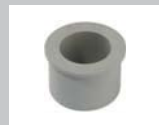
SPRINT RDE Reduction sealing insert / Reduzierdichteinsatz Thermoplastic elastomer / Thermoplastisches Elastomer IP 68, -40°C–100°C, M12–M63
