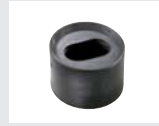
SPRINT FFD Flat cable sealing insert / Flachkabel-Formdichtung Thermoplastic elastomer / Thermoplastisches Elastomer IP 66, -40°C–100°C, M20
