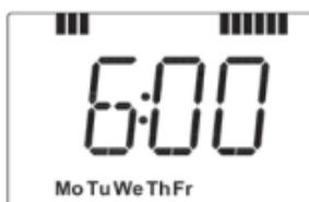
En Mode automatique, la température peut également être modifiée n'importe quand avec le bouton rotatif. La température modifiée est alors maintenue jusqu'au prochain point de commutation.
