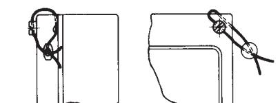
1. Rechte obere Deckelschraube ersetzen durch beiliegende Plombierschraube (mit Querloch)
