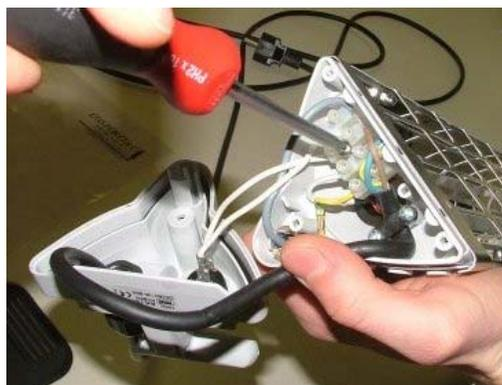
6. Svitare la vite di fissaggio della morsettiera.
