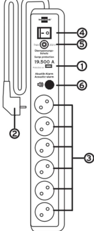
1. Overlastskydd med kontrollampa "skydd på"
