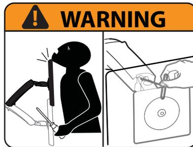
**WAARSCHUWING!** Rischio da energia immagazzinata: il meccanismo del braccio è sotto tensione e si muove rapidamente da sé non appena si toglie l'apparecchiatura a cui è collegato. Per questo motivo, **NON** rimuovere l'apparecchio a meno che il braccio non sia stata portata sulla posizione più alta. La mancata osservanza di questa precauzione può causare infortuni gravi e/o danni all'apparecchiatura.
