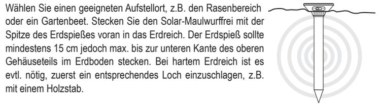
Wählen Sie einen geeigneten Aufstellort, z.B. den Rasenbereich oder ein Gartenbeet. Stecken Sie den Solar-Maulwurffrei mit der Spitze des Erdspießes voran in das Erdreich. Der Erdspieß sollte mindestens 15 cm jedoch max. bis zur unteren Kante des oberen Gehäuseteils im Erdboden stecken. Bei hartem Erdreich ist es evtl. nötig, zuerst ein entsprechendes Loch einzuschlagen, z.B. mit einem Holzstab.
