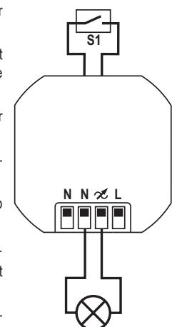
De aansluiting „N“ is de nuldraad, de aansluiting „L“ de geschakelde uitgang/fase/L.
