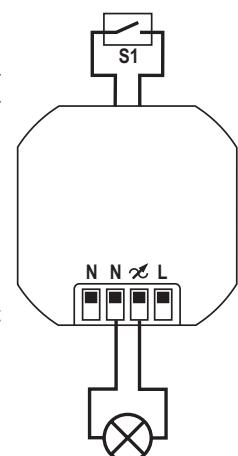
Le raccordement «N» est le conducteur neutre, le raccordement «xz» est la sortie de commutation/le conducteur de phase/L.
