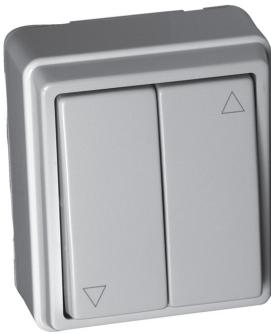
Druk om de motor te bedienen op de toets voor de gewenste richting. Als de motor in een bepaalde richting loopt is de bediening in de andere richting vergrendeld. Om schade aan de schakelaar te voorkomen dient u nooit de tweede bedieningstoets tegelijkertijd in te drukken. Om de motor in de andere richting te laten draaien zet u de eerste toets terug en drukt u daarna op de gewenste bedieningstoets.
