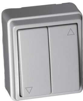
Zur Bedienung des Motors die Taste mit der gewünschten Laufrichtung betätigen. Wenn der Schalter in eine Laufrichtung eingeschaltet ist, ist die gleichzeitige Bedienung der anderen Laufrichtung gesperrt. Um Schäden am Schalter zu vermeiden, bitte niemals die zweite Taste gleichzeitig betätigen. Um den Motor in die andere Laufrichtung einzustellen, bitte zuvor die erste Taste zurückstellen und dann den Schalter in die gewünschte Stellung bringen.
