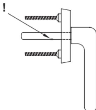
Damit der Fenstergriff ohne den Fenster-Drehgriffkontakt zu beschädigen auf diesen aufgeschoben werden kann, müssen alle Erhöhungen auf dem Vierkant beseitigt werden.
