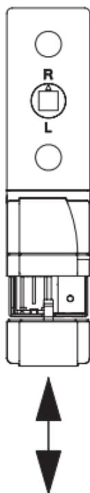
Schieben Sie den Batteriefachdeckel (Pfeil) nach unten und nehmen ihn anschließend ab. Legen Sie die mitgelieferten beiden Batterien LR44 polrichtig entsprechend den Polaritätsmarkierungen in das Batteriefach ein. Die Batterien werden durch die Vorspannung der Batteriekontakte im Batteriefach festgehalten.
