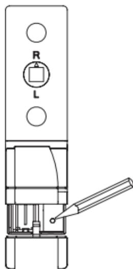
Um den Fenster-Drehgriffkontakt in den Anlernmodus zu bringen, drücken Sie mit einem spitzen Gegenstand auf die Anlerntaste. Die Geräte-LED blinkt orange. (Abbruch durch kurze Betätigung der Anlerntaste, die Geräte-LED leuchtet dann rot auf.) Wenn kein Anlernen erfolgt, wird der Anlernmodus automatisch nach 20 Sekunden beendet. Befinden sich andere Geräte im Anlernmodus, werden diese angelernt.
