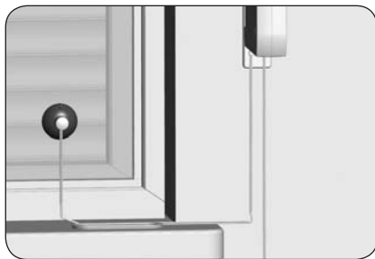
Exemplo para a montagem superficial (exterior)
