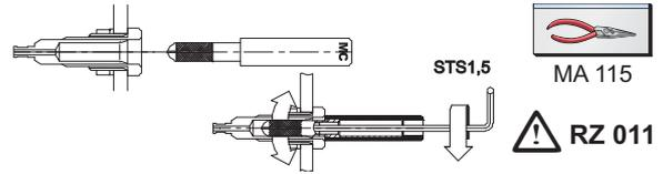
Adapter aus Messing zum Festschrauben in Ø 4 mm-Buchsen. Durch Anziehen einer Innenschraube spreizt sich der Ø 4 mm-Stecker dieses Adapters auf, so dass er fest in der Buchse sitzt und im montierten Zustand vollen Berührungsschutz bietet. Starre Ø 4 mm-Buchse im Isolierkörper, geeignet zur Aufnahme federnder Ø 4 mm-Stecker mit starrer Isolierhülse.
