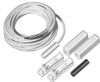
**Encastrement:** Le perçage de trous de (8,0 + 0,2) mm est nécessaire tant pour l'encastrement de l'interrupteur que pour celui de l'aimant. L'introduction de l'interrupteur dans le trou doit être aisée. Cependant il doit y être coincé, de sorte qu'il ne puisse pas en être retiré sans autre moyen technique. Ne pas encastrer le contact par la force pour éviter tout endommagement. L'encastrement de contacts dans des matériaux ferromagnétiques ou à noyau ferromagnétique n'est pas autorisé.
