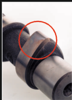
Arbol de levas protegido por MotorProtect.
