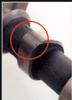
Desgaste notable de las levas.
