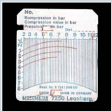
Diagrama de compresión antes del enjuague del motor.
