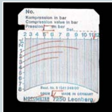
Compressie-diagram voor de motorspoeling.
