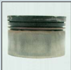
Dépôts sur les pistons avant le rinçage du moteur.
