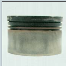
Deposiciones en los anillos de los pistones antes del enjuague del motor.
