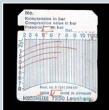
Diagramme de compression avant le rinçage du moteur.
