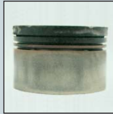
Ablagerungen an den Kolbenringen vor der Motorspülung.
