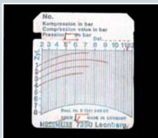
Diagramma di compressione, prima del lavaggio motore.
