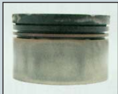
Depositi sui segmenti, prima del lavaggio motore.
