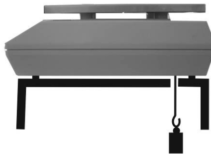
Abb. 1: Einrichten der Waage für Unterflurwägungen
