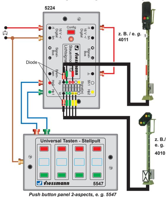
**Abb. 3 Anschluss an Licht-Einfahrtsignal und Vorsignal Fig. 3**
