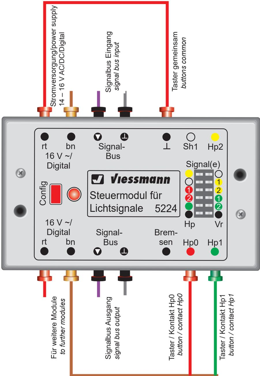
**Abb. 2 Anschluss an Licht-Blocksignal und Vorsignal Fig. 2**
