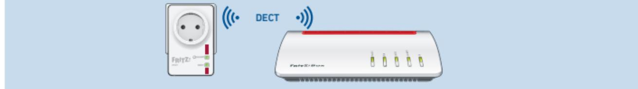
**i** Falls die LED „DECT“ dauerhaft blinkt, testen Sie eine andere Steckdose, die näher an der FRITZ!Box ist. Die Steckdose muss innerhalb der Reichweite des DECT-Funknetzes der FRITZ!Box liegen.
