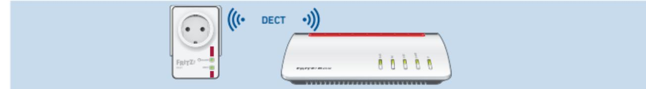
**i** Als de led "DECT" blijft knipperen, test dan een andere contactdoos dichterbij de FRITZ!Box. De contactdoos moet zich binnen de reikwijdte van het DECT-signalen van de FRITZ!Box bevinden.
