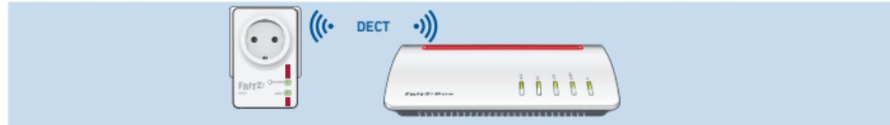
**i** Si la LED « DECT » clignote en continu, essayez une autre prise de courant plus proche de votre FRITZ!Box. La prise de courant doit se trouver dans le rayon d'action du réseau sans fil DECT de la FRITZ!Box.
