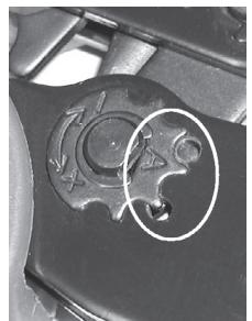
**Zwangssperre über Lösehebel entriegeln**
