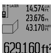
Mesurez ensuite la longueur **B<sub>2</sub>** du deuxième mur. La valeur de mesure individuelle affichée sur la ligne médiane des valeurs de mesure **a** est additionnée à la longueur **B<sub>1</sub>**. La somme des deux longueurs (« **sum** », affichée sur la ligne inférieure des valeurs de mesure **a**), est multipliée par la hauteur mémorisée **A**. La valeur de la surface totale est indiquée sur la ligne de résultat **c**.
