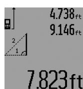
Une fois la dernière mesure terminée, le résultat de la distance recherchée « **E** » est affichée sur la ligne de résultat **c**. Les valeurs de mesure individuelles sont sur les lignes de valeurs de mesure **a**.
