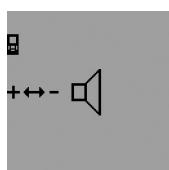
Pour mettre en marche et pour éteindre le signal sonore, appuyer plusieurs fois sur la touche de commutation de fonction **3** jusqu'à ce que l'affichage de réglage du son apparaisse sur l'afficheur. Choisissez le réglage souhaité en appuyant sur la touche plus **6** ou la touche moins **12**. Le réglage du son sélectionné est maintenu quand l'appareil de mesure est mis en ou hors fonctionnement.
