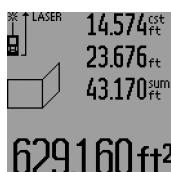
Ukurkan kini panjang **B**<sub>2</sub> dari dinding kedua. Nilai pengukuran tunggal yang tampil pada garis nilai pengukuran yang di tengah **a** ditambahkan pada panjang **B**<sub>1</sub>. Jumlah dari kedua panjang („**sum**“, tampil pada garis nilai pengukuran di bawah **a**) dikalikan dengan tinggi yang direkam **A**. Jumlah hasil pengukuran luas tampil pada garis hasil pengukuran **c**.
