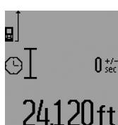
Appuyez ensuite sur les touches Mesurer **7** pour activer le faisceau laser et pour viser le point cible. Appuyez à nouveau sur les touches Mesurer **7** pour déclencher la mesure. La mesure s'effectue au bout du laps de temps sélectionné. La valeur de la mesure est indiquée sur la ligne de résultat **c**.
