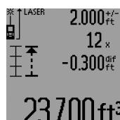
Par une distance totale de 23,7 ft, il manque 0,3 ft jusqu'à ce que la valeur de traçage 2,0 ft soit comprise 12 fois. Augmentez la distance entre l'appareil de mesure et le point de départ de 0,3 ft et tracez ensuite la longueur.
