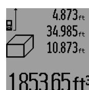
Setelah pengukuran ketiga rampung, isi dihitungkan secara otomatis dan tampil pada garis hasil pengukuran **c**. Nilai-nilai pengukuran satu per satu tampil pada garis-garis nilai pengukuran **a**.
