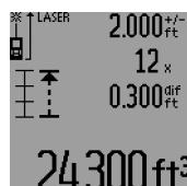
Par une distance totale de 24,3 ft, la valeur de traçage 2,0 ft est comprise 12 fois. En outre, la distance totale comprend encore un reste de 0,3 ft. Raccourcissez la distance entre l'appareil de mesure et le point de départ de la valeur de différence de 0,3 ft et tracez ensuite la longueur.
