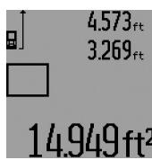
Setelah pengukuran kedua rampung, luas dihitungkan secara otomatis dan tampil pada garis hasil pengukuran **c**. Nilai-nilai pengukuran satu per satu tampil pada garis-garis nilai pengukuran **a**.
