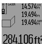
Puis mesurez la longueur **B<sub>1</sub>** du premier mur. La surface est automatiquement calculée et affichée sur la ligne de résultat **c**. La valeur de mesure de la longueur est sur la ligne médiane des valeurs de mesure **a**. Le laser reste activé.
