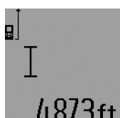
กดปุ่มสำหรับการวัด 7 หนึ่งครั้ง เพื่อเปิดคำแนะนำ และกดอีกครั้งหนึ่ง เพื่อการวัด ค่าจากการวัดจะแสดงในบรรทัดผลลัพธ์ c
