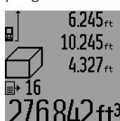
Untuk menampilkan nilai pengukuran yang direkam, tekan tombol **15**. Pada display tampil nilai pengukuran yang terakhir, selain itu indikator untuk daftar nilai pengukuran **d** serta satu bilangan sebagai nomor urut dari pengukuran yang ditampilkan.
