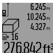
Pour appeler les mesures mémorisées, appuyez sur la touche **15**. Le résultatat de la dernière mesure apparaît sur l'afficheur, avec l'indicateur de la liste des valeurs de mesure **d** ainsi qu'un compteur pour la numérotation des mesures affichées.
