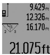
Setelah pengukuran terakhir rampung, hasil dari jarak yang diukur „E“ tampil pada garis hasil pengukuran c. Nilai-nilai pengukuran satu per satu tampil pada garis-garis nilai pengukuran a.
