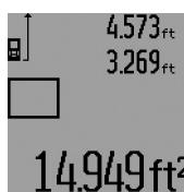
Une fois la deuxième mesure terminée, la surface est automatiquement calculée et affichée sur la ligne de résultat **c**. Les valeurs de mesure individuelles sont sur les lignes de valeurs de mesure **a**.
