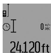
Setelah itu, tekan tombol untuk pengukuran 7, untuk menghidupkan sinar laser dan membidikkan pada titik target. Tekan tombol untuk pengukuran 7 sekali lagi, untuk memulai pengukuran.
