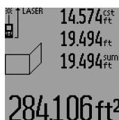
Setelah itu, ukurkan panjang **B**<sub>1</sub> dari dinding pertama. Luas dihitungkan secara otomatis dan tampil pada garis hasil pengukuran **c**. Nilai pengukuran panjang tampil pada garis nilai pengukuran yang di tengah **a**. Sinar laser tetap hidup.
