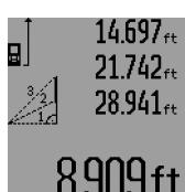
Une fois la dernière mesure terminée, le résultat de la distance recherchée « **E** » est affichée sur la ligne de résultat **c**. Les valeurs de mesure individuelles sont sur les lignes de valeurs de mesure **a**.
