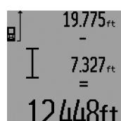
Pour soustraire des valeurs de mesure, appuyez sur la touche **12** ; pour confirmer, « - » apparaît sur l'afficheur. Le procédé suivant est analogue à « Additionner des valeurs de mesure ».
