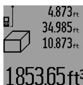
Une fois la troisième mesure terminée, le volume est automatiquement calculé et affiché sur la ligne de résultat **c**. Les valeurs de mesure individuelles sont sur les lignes de valeurs de mesure **a**.
