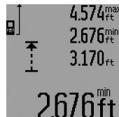
ค่าต่ำสุดหรือสูงสุดที่แสดงในบรรทัดผลลัพธ์ c ขึ้นอยู่กับรูปแบบการวัดที่ตั้งไว้ ค่านี้จะถูกเขียนบันทุมอย่างกว้างๆ ที่สุดที่แสดงไว้ หรือมากกว่าค่าสูงสุด ("max") ค่าต่ำสุด ("min") และค่าจากการวัดปัจจุบันจะแสดงในบรรทัดค่าจากการวัด a
