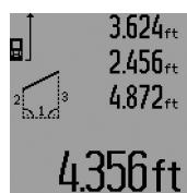
Setelah pengukuran terakhir rampung, hasil dari jarak yang diukur „E“ tampil pada garis hasil pengukuran c. Nilai-nilai pengukuran satu per satu tampil pada garis-garis nilai pengukuran a.
