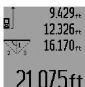
Une fois la dernière mesure terminée, le résultat de la distance recherchée « **E** » est affichée sur la ligne de résultat **c**. Les valeurs de mesure individuelles sont sur les lignes de valeurs de mesure **a**.
