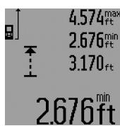
atau lebih besar dari nilai minimal atau nilai maksimal sebelumnya. Pada garis nilai pengukuran **a** tampil nilai pengukuran maksimal („**max**“), minimal („**min**“) dan nilai pengukuran yang aktuil. Untuk mengakhiri pengukuran minimum/maksimum, tekan sebentar tombol untuk pengukuran **7**. Jika tombol untuk pengukuran ditekan sekali lagi, pengukuran distart kembali.
