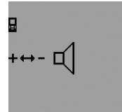
Untuk menghidupkan dan mematikan nada sinyal, tekan tombol untuk mengganti fungsi **3** sekian kali, hingga pada display tampil simbol untuk penyetelan nada sinyal. Dengan cara menekan
