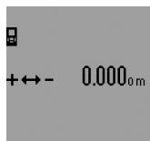
Pour changer l'unité de mesure, appuyer plusieurs fois sur la touche de commutation de fonction **3** jusqu'à ce que l'affichage pour l'unité de mesure apparaisse sur l'afficheur. Choisissez l'unité de mesure souhaitée en appuyant sur la touche plus **6** ou la touche moins **12**.
