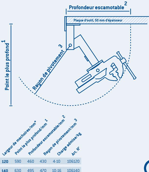
\* L'indication se réfère à l'étau HEUER. Également compatible avec des produits de marques de fabrication étrangères; la charge admise doit être cependant contrôlée. Au moment de la commande, veuillez absolument donner s.v.p. la marque de fabrication et la taille.
