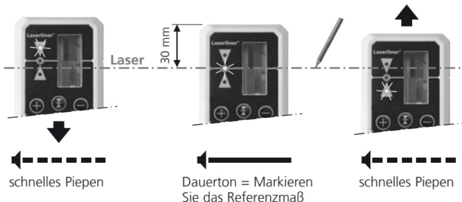
Der Laser-Empfänger verfügen über 2 Toleranzbereiche:
