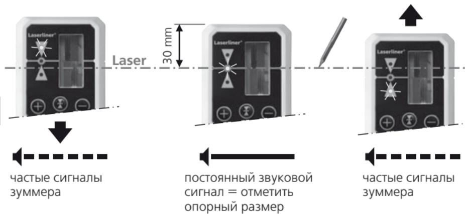
Лазерные приемники имеют 2 диапазона допусков:
