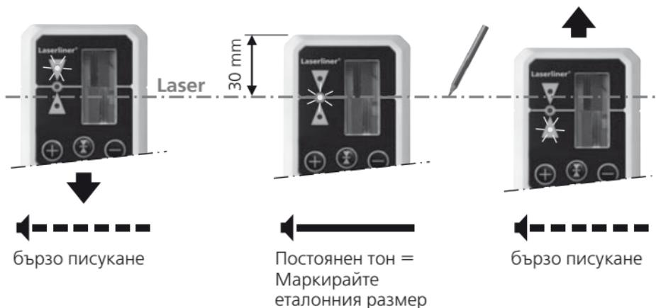
Лазерният приемник разполага с две зони на допуск:
