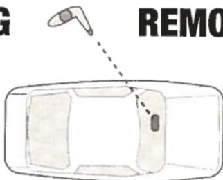
**Richten Sie die Fernbedienung direkt auf das Alarmgerät auf der Fahrerseite.**
