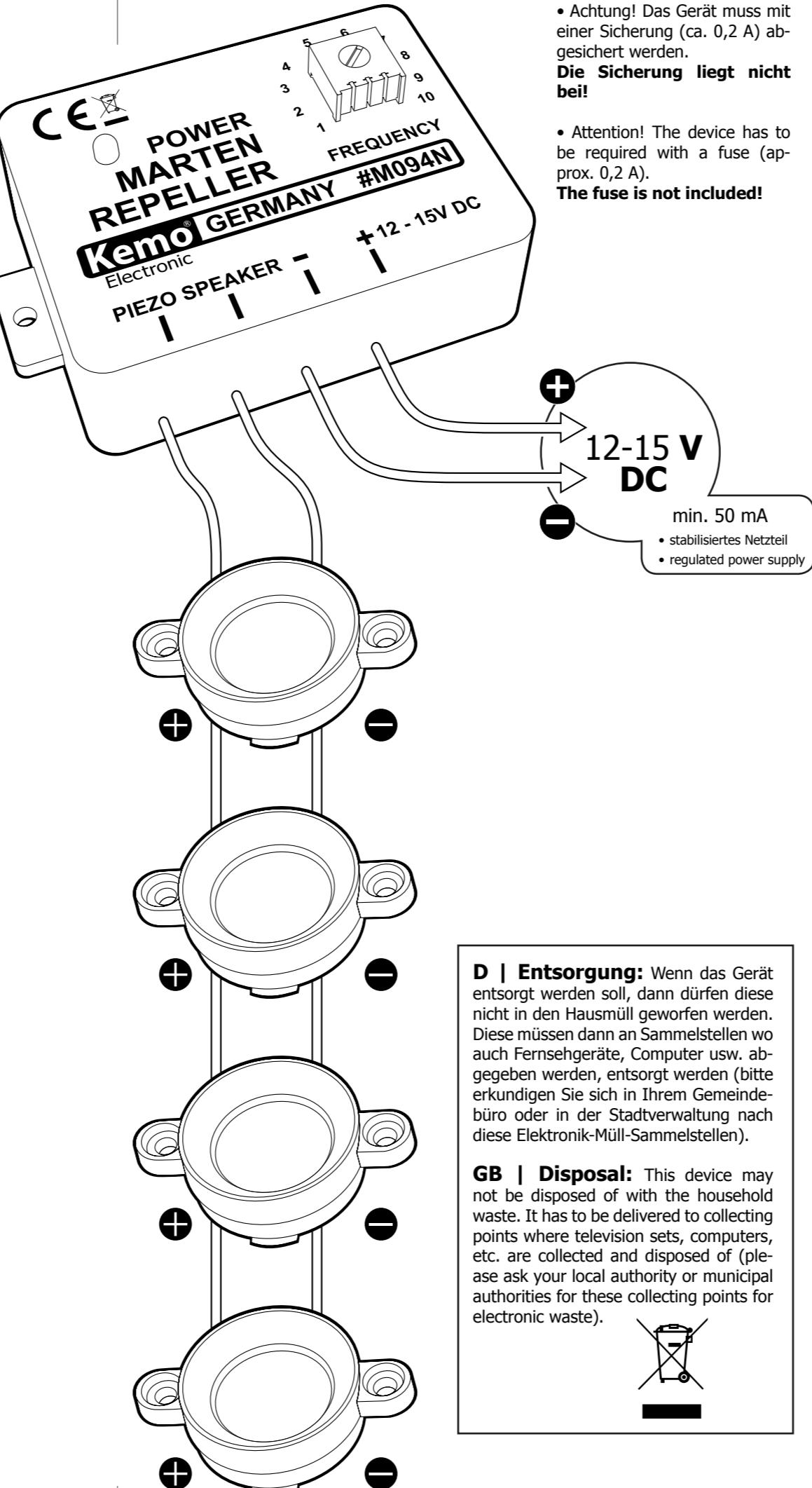
• Achtung! Das Gerät muss mit einer Sicherung (ca. 0,2 A) abgesichert werden.
