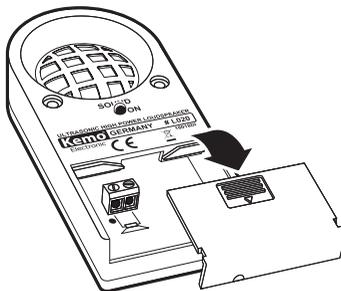
**D** Unter dieser Klappe ist die Anschlussklemme. | **GB** The connecting terminal is under this flap. | **E** El borne de conexión se encuentra debajo de esta chapaleta. | **F** On trouve le borne de raccord sous ce clapet. | **NL** Onder de klep zitten de aansluitklemmen. | **PL** Pod tą klapką knajduje się zacisk przyłączeniowy. | **RUS** Под этой крышкой находятся разъемы для подключения кабеля.
