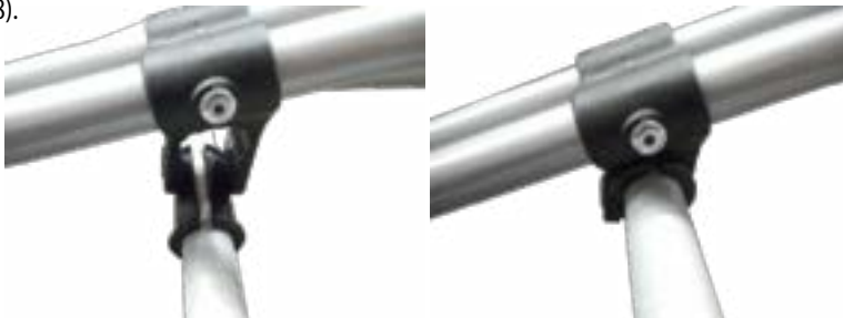
Figure 6 e 7: Posizionamento barra di espansione
