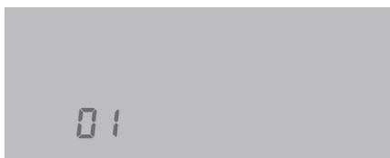
3 Zvolte požadovaný uživatelský parametr (01 až 12) pomocí tlačítka **B** **(▼)** a **D** **(▲)** a potvrďte volbu stiskem tlačítka **SET C**.
