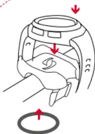
Montáž držáku na jízdní kolo. Upevněte držák na řídítka jízdního kola.
