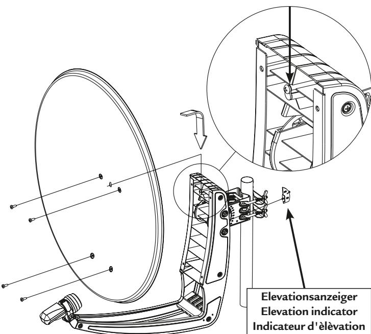
**5.** Die vier Reflektor-Befestigungsschrauben mit einem maximalen Drehmoment von 10 N/m anziehen.
