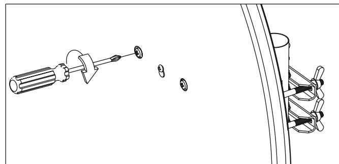
**6.** Die Antenne auf den gewünschten Satelliten ausrichten, danach die seitlichen Muttern und die hinteren Flügelmuttern anziehen (maximaler Drehmoment 15 N/m).
