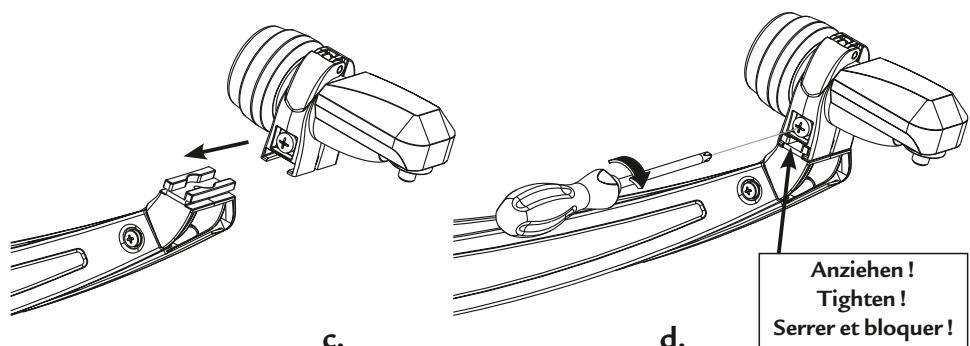
**4.** Den Elevationsanzeiger in das Rückenteil einstecken.
