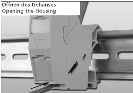
Gehäuseoberteil mittels eines Schraubendrehers lösen und entfernen.
