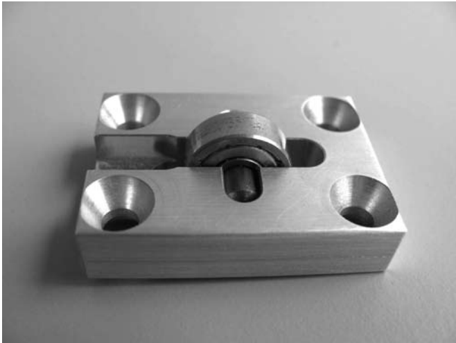
Kugellager mit Zylinderstift nach der Montage in die Nut der Kugellagerhalterung einlegen.
