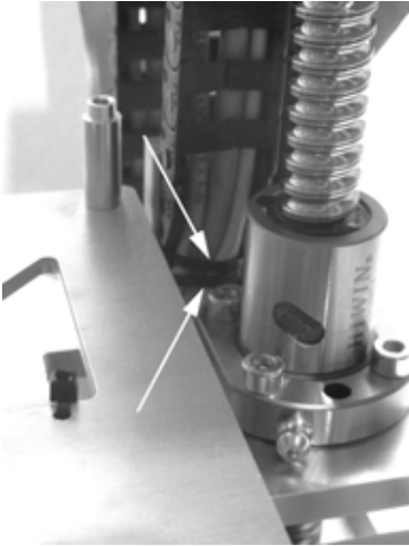
Am Schleppkettenendstück an der Y-Platte zwei große Kabelbinder (142 mm) zur Zugentlastung anbringen.
