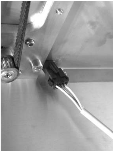
Leitung 16 an den Steckverbinder des Z-Motors anstecken.
