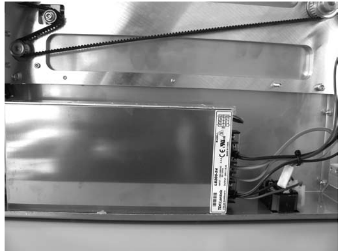
Netzteil mit den 4 Schrauben an der Rückblende befestigen.
